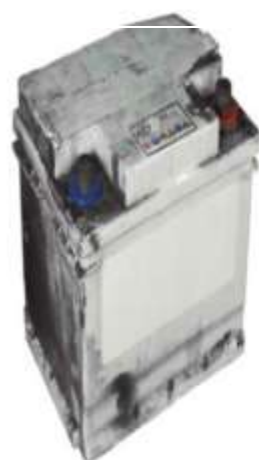
En las baterías de plomo ocurren reacciones de oxidación-reducción que liberan energía utilizable.
