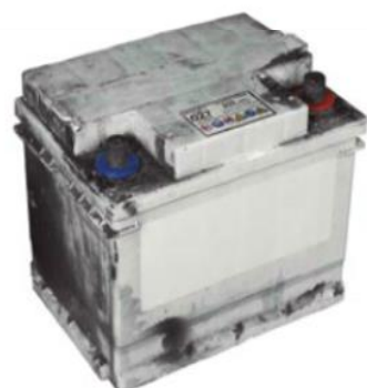
En las baterías de plomo ocurren reacciones de oxidación-reducción que liberan energía utilizable.
